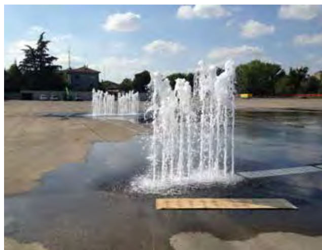
Uscita acqua per irrigazione pavimentazione del Paddock 2 dove vengono effettuati i test di aquaplaning
