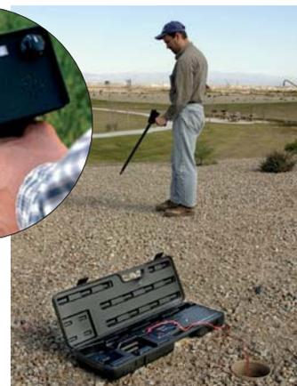
dans la maintenance des systèmes et des questions que les installateurs et les mainteneurs ont sur le terrain. Plus d'un récepteur de 70 cm, le haut-parleur externe et l'affichage de la batterie, le localisateur SC-Pro7 ajoute des composants électroniques sophistiqués afin de minimiser le bruit pour un son clair.
