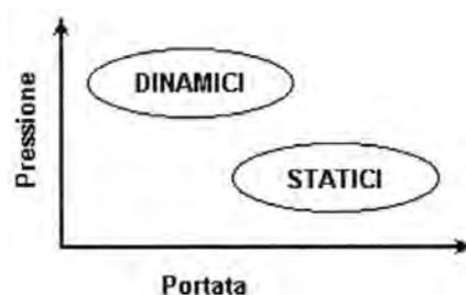
Avendo caratteristiche di funzionamento diverse, quindi, gli irrigatori della statici non possono funzionare assieme a quelli della dinamici, il che ci obbliga a suddividere l'impianto perlomeno in 2 "zone irrigue", una con irrigatori statici ed una con irrigatori dinamici.
