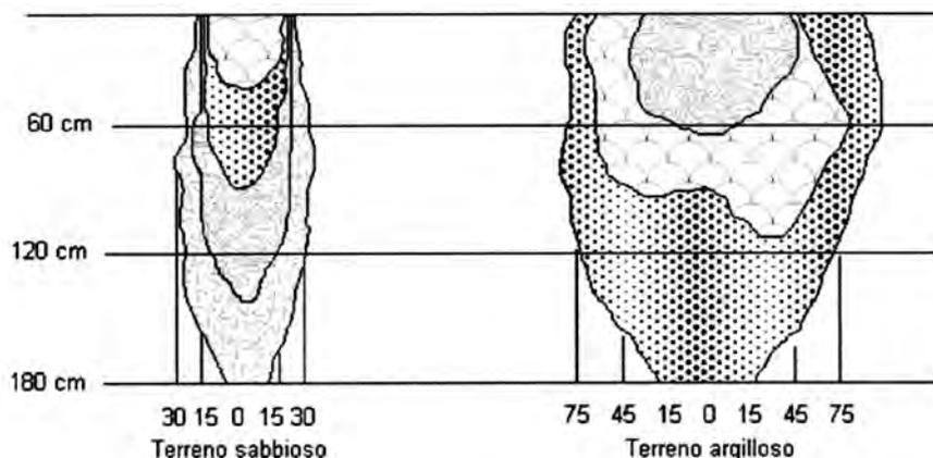
Il principio conduttore, nella preparazione del terreno, è garantire la regolarità del passaggio dell'acqua in profilo con uniforme distribuzione di macro e di micropori.
