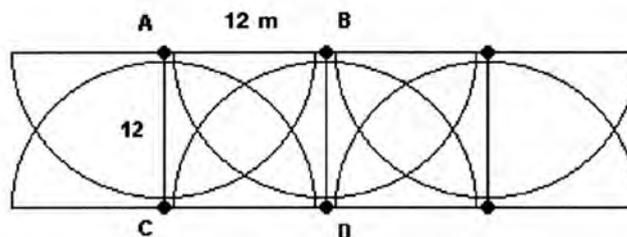
si ha che l'apporto idrico di ciascuno degli irrigatori A, B, C e D nel quadrato da essi delimitato è di 6 l/min. Ne consegue che la portata totale che insiste sul quadrato ASCD ad opera dei quattro irrigatori risulta di 24 l/min. Applicando la formula per l'intensità della precipitazione si ha:
