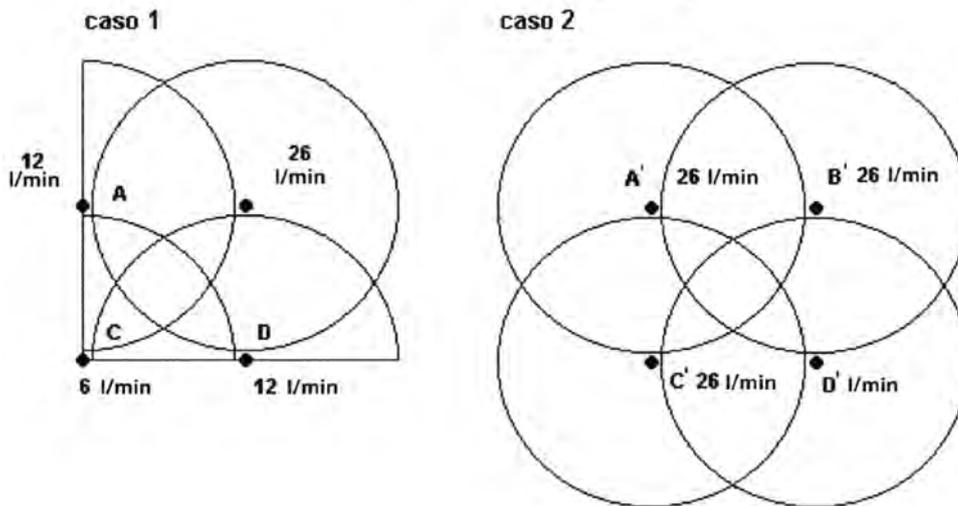
gli irrigatori utilizzati sono sempre dinamici con le seguenti caratteristiche:  $P = 35$  m.c.a.,  $Q = 26$  l/min; 12 l/min e 6 l/min.
