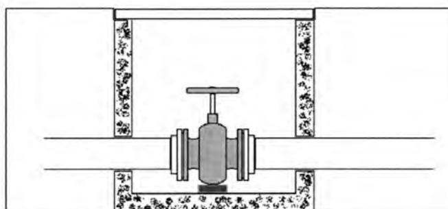
Esempio classico di una saracinesca a corpo ovale inserita su tubazione di pari diametro, ma che potrebbe essere di diversa natura: PVC/PE, PE/ferro ecc.
