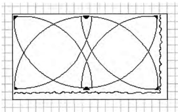
Scelto l'irrigatore si va a posizionarlo: poiché il lato lungo di 19 metri non è divisibile in parti da 10 metri, si andrà a posizionare gli irrigatori ad una distanza pari a 9,5 metri.
