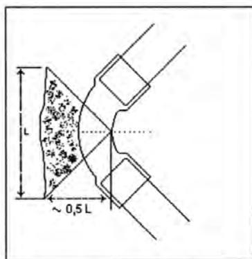
Pianta di ancoraggio per la curva a 90°
