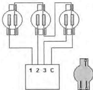
Usufruento dello stesso scavo dell'alimentazione idraulica, si possono posare i cavi di collegamento dalle elettrovalvole al programmatore. Per le loro caratteristiche di resistenza ed impermeabilità si consiglia l'uso di cavi specifici con guaina in polietilene.
