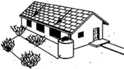
*Sistema di raccolta dell'acqua formato da tetto, grondaia, pluviale, serbatoio e sistema di distribuzione a microirrigazione.
